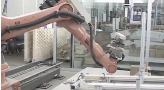
Figure 14 : Robot fabricant le mur de brique du vignoble
