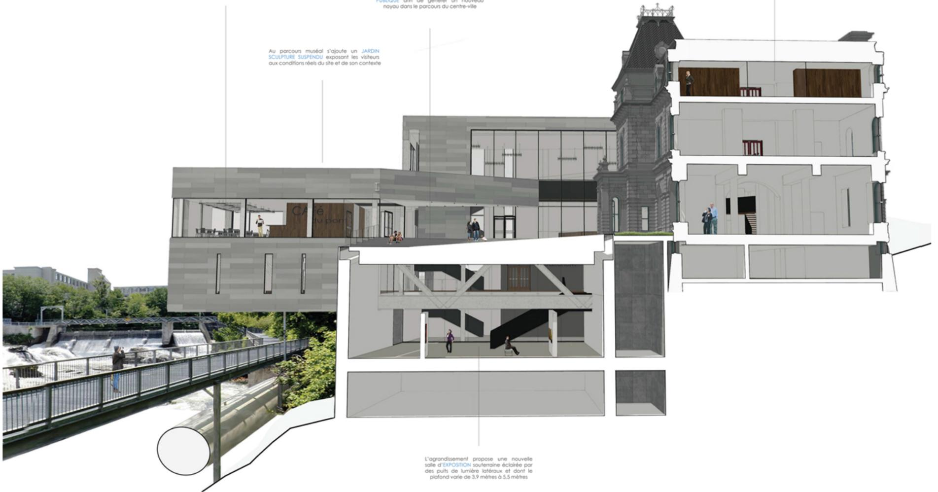
L'agrandissement propose une nouvelle salle d'EXPOSITION souterraine éclairée par des puits de lumière latéraux et dont le plafond varie de 3,9 mètres à 5,5 mètres
