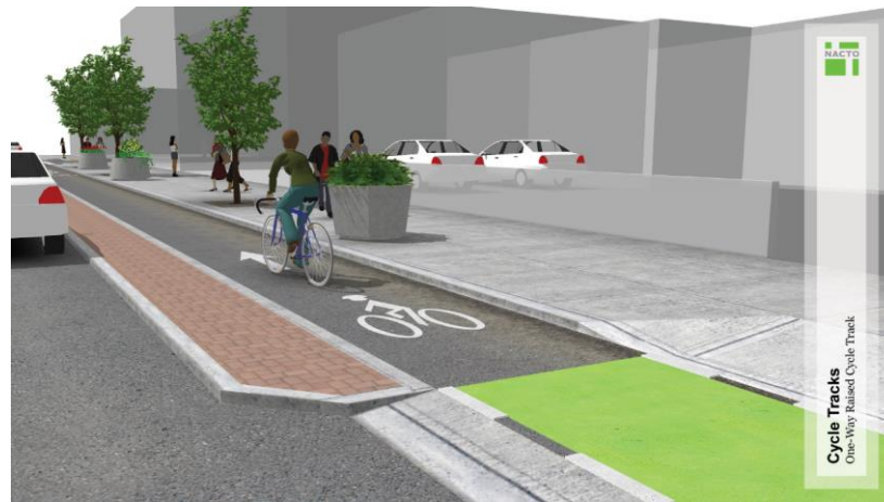
Figure 45 Exemple de piste cyclable surélevée qui pourrait être aménagée sur Joffre (tirée de NACTO, 2014)
