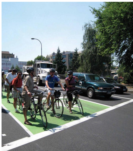
Figure 34 Aire d'attente prioritaire pour cyclistes sur une intersection à Portland, États-Unis (tirée de NACTO, 2014)
