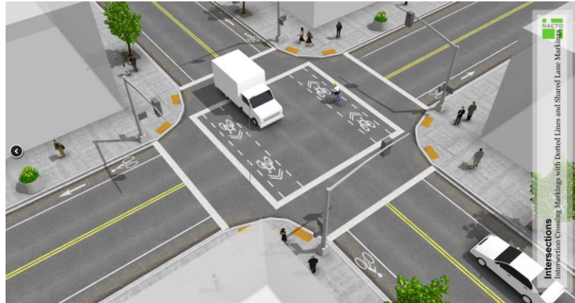
Figure 46 Exemple d'un marquage continu dans une intersection (tirée de NACTO, 2014)
